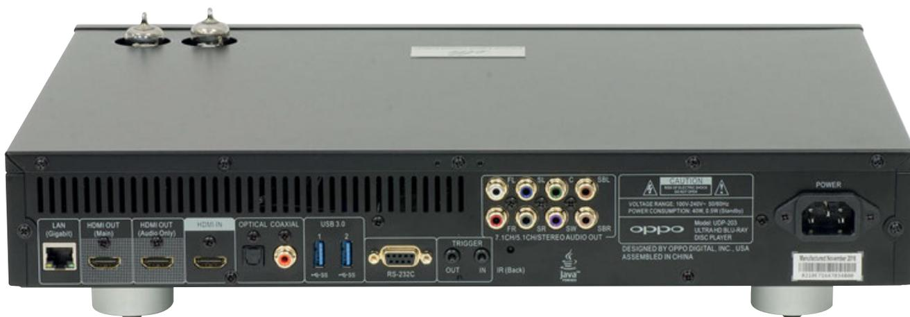
La prospettiva posteriore è indistinguibile dalla versione standard. Sono presenti le uscite analogiche (multicanale) e quelle digitali, ottica e coassiale. Le prese USB 3.0 per le memorie di massa sono due (più una terza 2.0 sul frontale) mentre le HDMI sono tre, una in ingresso, una di uscita audio e una di uscita video UHD. Invisibile l'antenna WiFi, integrata nel fianchetto sinistro, mentre c'è la connessione Ethernet RJ45.
