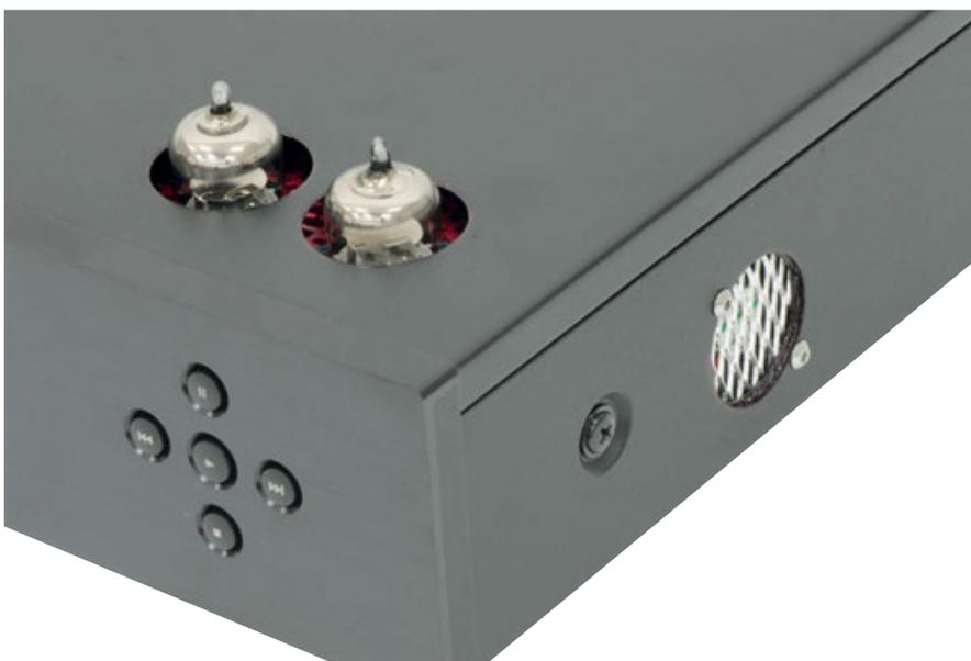
Le due valvole ECC88 NOS sporgono oltre le aperture praticate sulla parte superiore e richiedono una certa attenzione per evitare possibili danneggiamenti.
