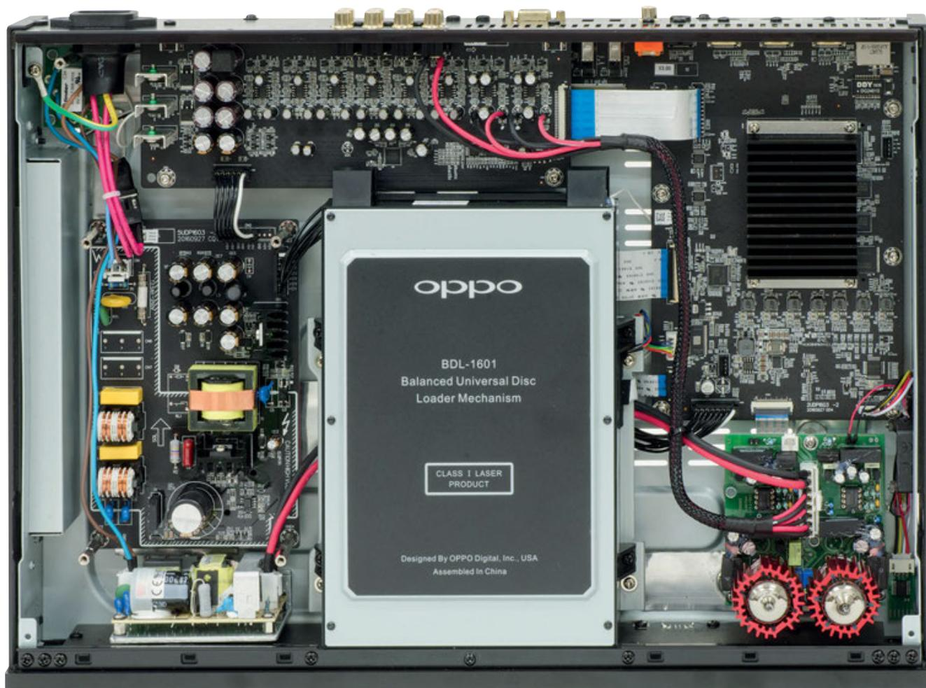
Labtek ha inserito i circuiti aggiuntivi nei pochi spazi vuoti presenti nell'UDP 203. Il circuito valvolare è a ridosso del frontale praticamente dietro la tastiera dei comandi. Il cablaggio è realizzato con conduttori Van Den Hul, molto ordinato. Da notare la schermatura nella zona della sezione di alimentazione in cui sono alloggiati i circuiti a commutazione.
